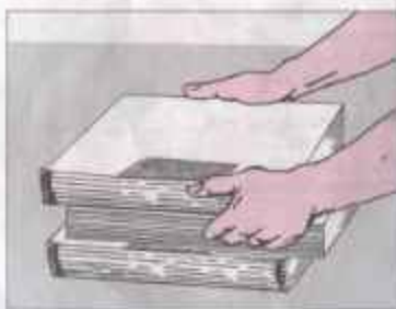
УКЛАДКА БЛОКОВ В ШТАБЕЛН
